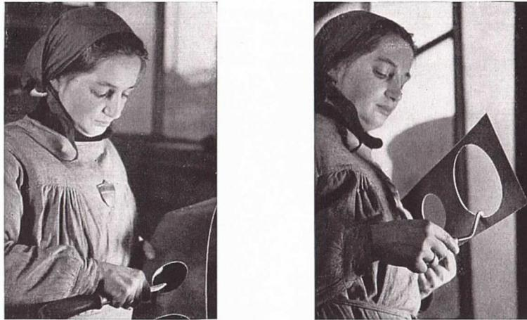
Abb. 15 Entgraten von Durchbrüchen (links das alte Verfahren — rechts die verbesserte Arbeitsweise)
